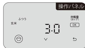
6. ポットヒーターの電源を入れ、炊飯を選択し、「玄米・ふつう」を選択したら、炊飯量を設定し、「OK」を押す。
